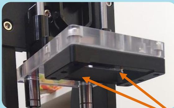
上固定底座的弹性探针 (匹配电模块)
